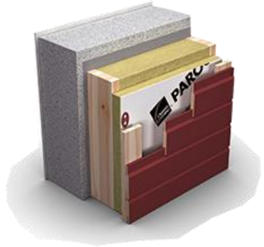
Harkkoseinän ulkopuolinen lisälämmöneristys
