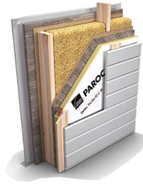
Purueristeisen seinän ulkopuolinen lisälämmöneristys
