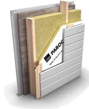
Purueristeisen seinän eristeiden vaihto
