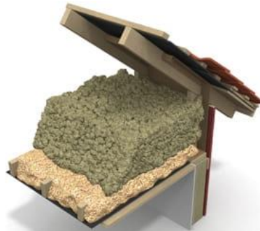
Harjakaton lisälämmöneristämien puhallusvillalla
